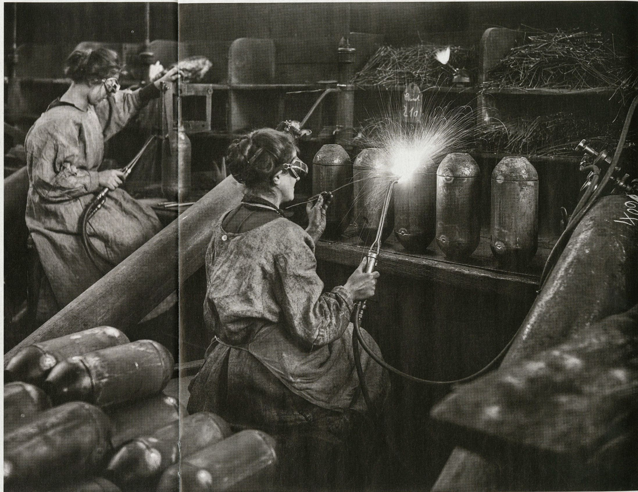
Vrouwen lassen vinnen aan mortiergranaten in de fabriek van Saint-Etienne, 1916. In opdracht van het Franse leger documenteerde Isidore Aubert de oorlogsindustrie in de departementen Rhône en Loire. Zijn beelden doen nu eens denken aan Vermeer, dan weer aan het sociaal realisme van Meunier.
